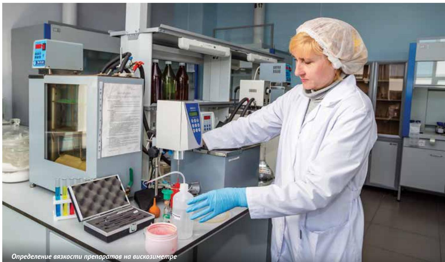
*Определение вязкости препаратов на вискозиметре*
