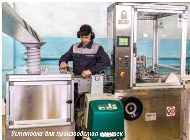
Установка для производства крышек
