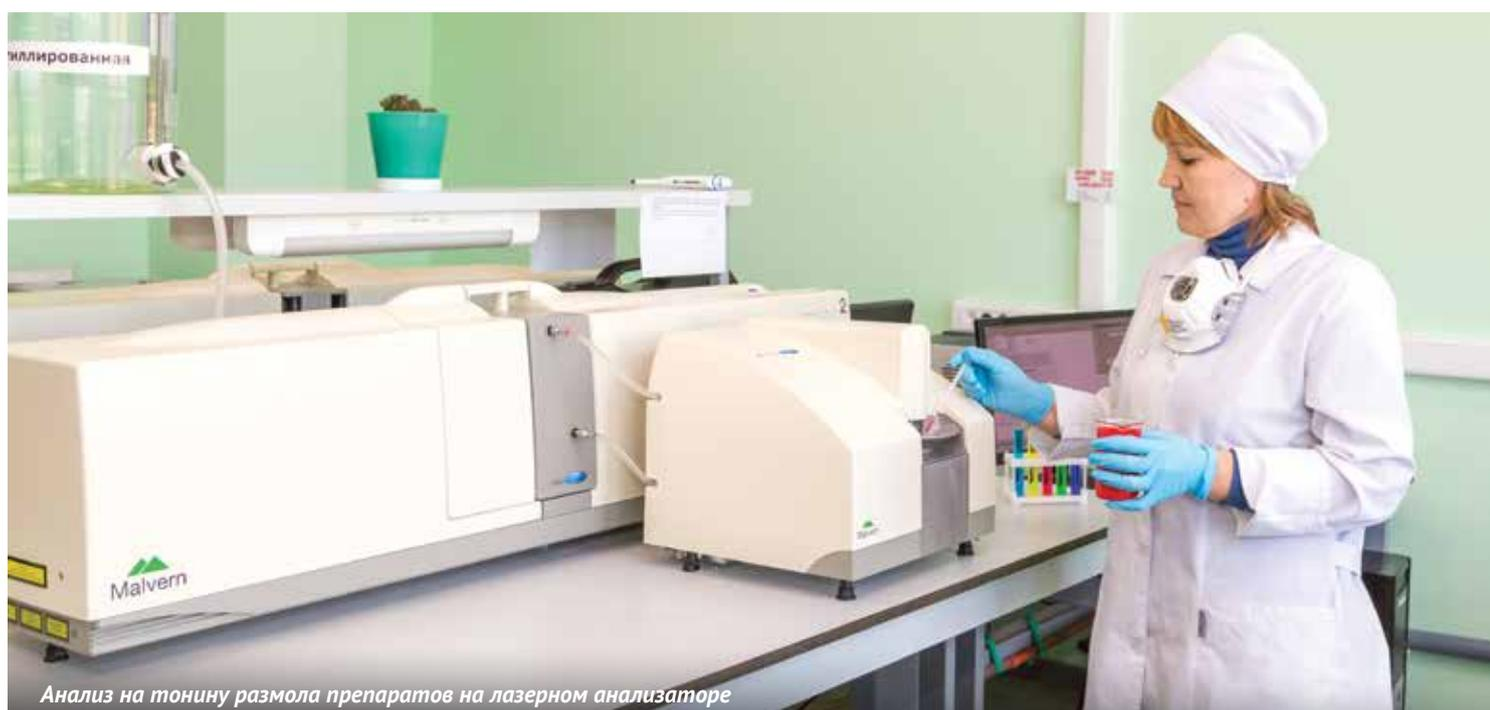
*Анализ на тонину размола препаратов на лазерном анализаторе*
