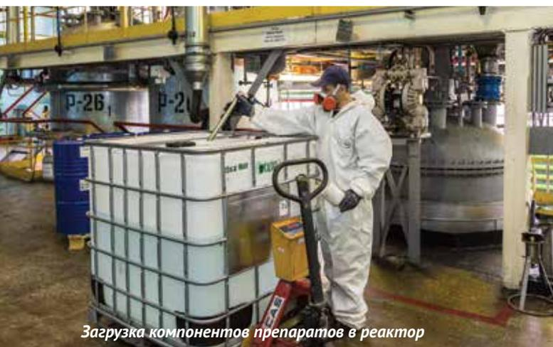
Загрузка компонентов препаратов в реактор
