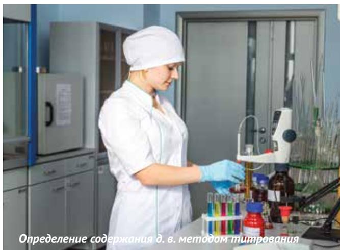
*Определение содержания д. в. методом титрования*
