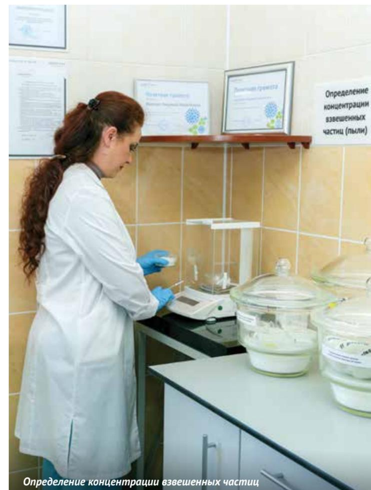
Определение концентрации взвешенных частиц
