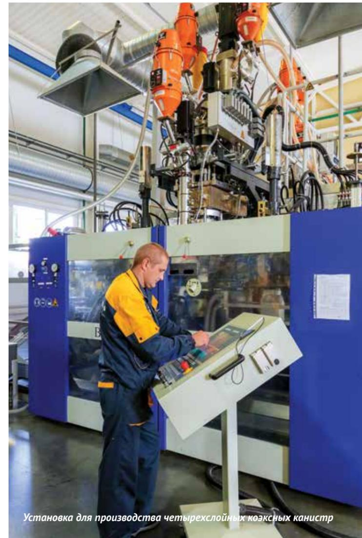
Установка для производства четырехслойных коэксных канистр
